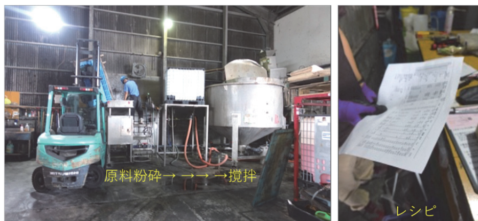
写真1 豚用エコフィード（リキッド）の製造ラインとレシピ （作業員の左にある機械で固体原料を粉砕し、パイプを通して右にある大きな攪拌機へ） 資料：筆者撮影。
